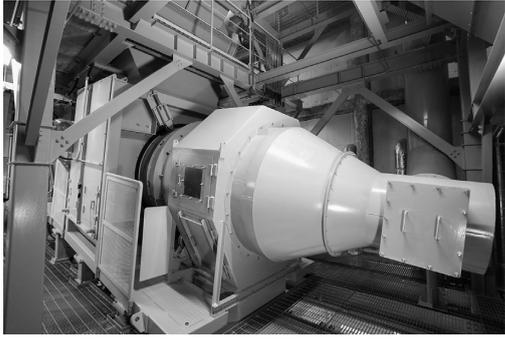
図2 プラスチック用回転式比重差選別機
