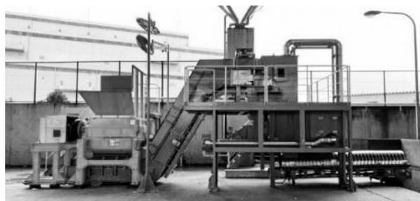
図1 ベッドマット処理装置
