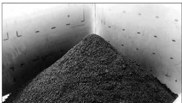
図3 SDRインパクト脱水汚泥の状態
