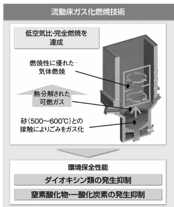
図1 流動床式ガス化燃焼炉概念図
