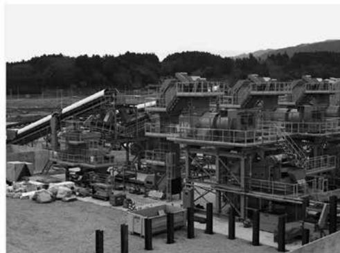
(f) 仮設の津波堆積物処理施設
