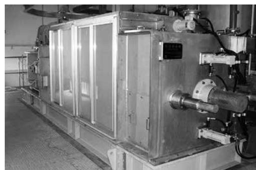
軸摺動式スクリープレス脱水機
