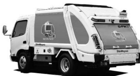
図 3 プラグイン充電方式 イーキューブ E2 車両外観
