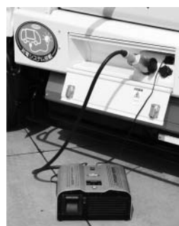
写真3 給電システム
