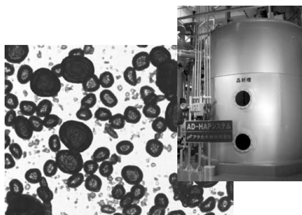
回収した HAP の顕微鏡写真と晶析槽
