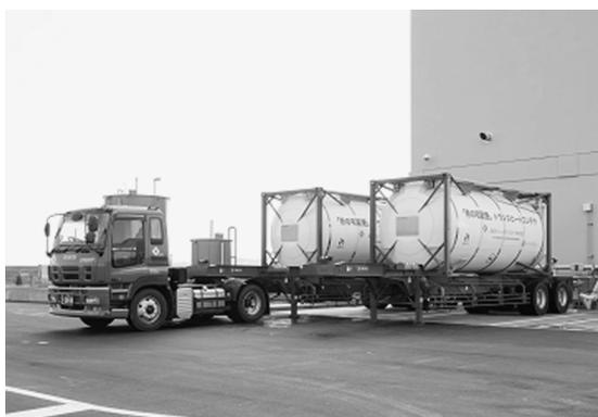
図4 トランスヒートコンテナ
