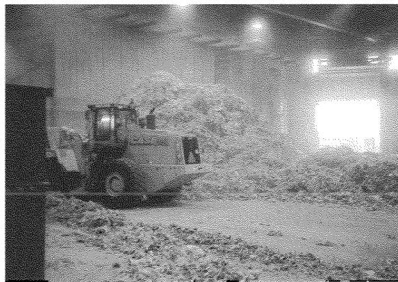
写真2 産廃ごみプラットホーム兼ピット
