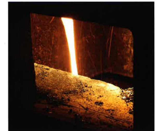
Slag discharge conditions
